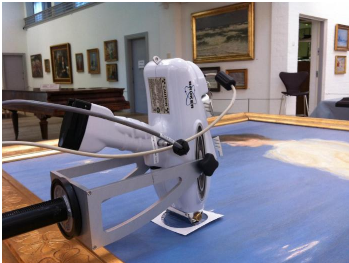
Fig. 5b. XRF måling udført på Skagens Museum af blå farveområde i maleriet P.S. Krøyer: Sommeraften ved Skagen . Ny Carlsberg Glyptotek, dep. på Skagens Museum. Se fig. 5a.
